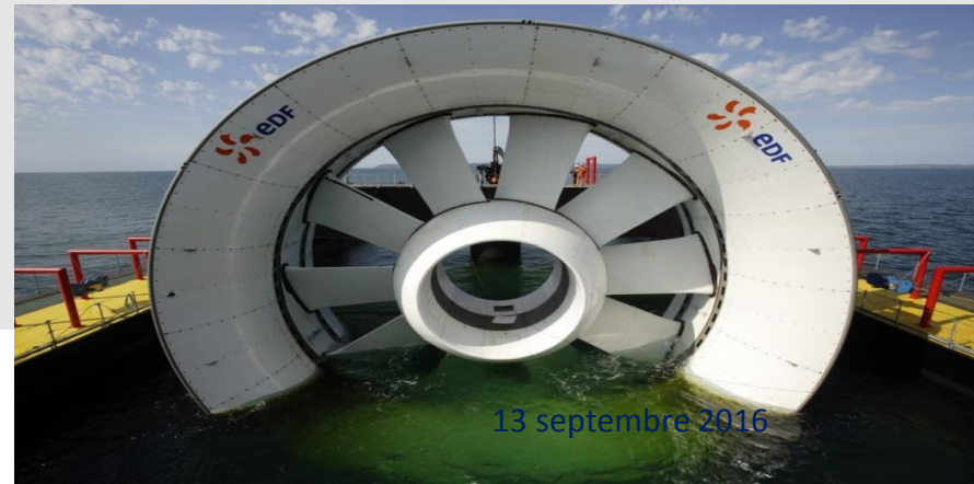
Hydrolienne OPEN HYDRO (2 MW – 850 t) Projet EDF – Paimpol-Bréhat
